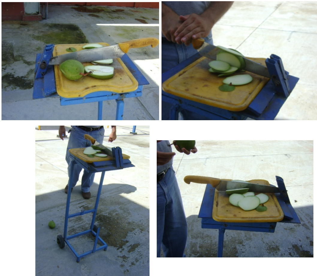
Ejemplo de cómo adaptar un cuchillo en una guillotina
