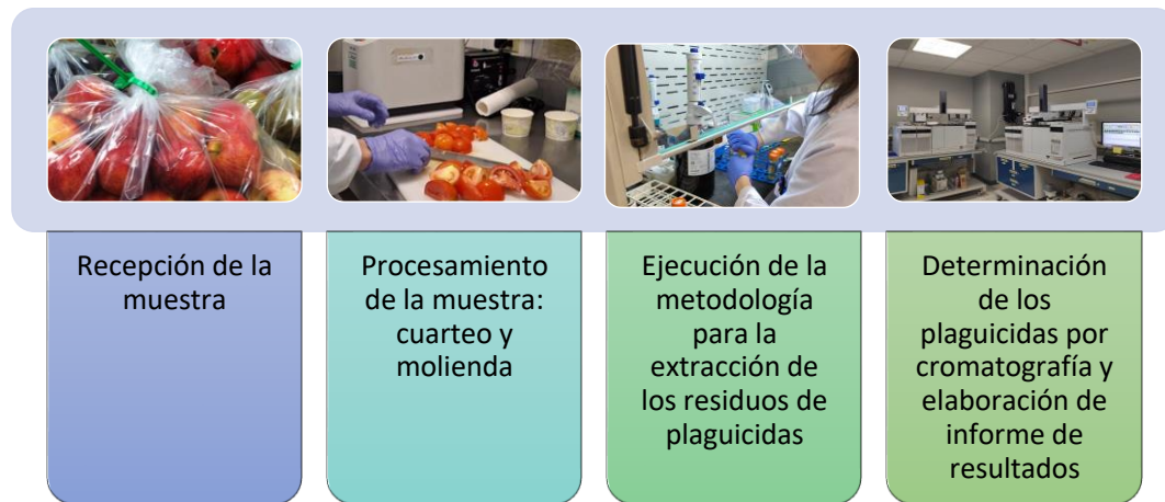
Figura 4. Proceso de análisis de vegetales frescos para la determinación de residuos de plaguicidas en el LRE, SFE.
